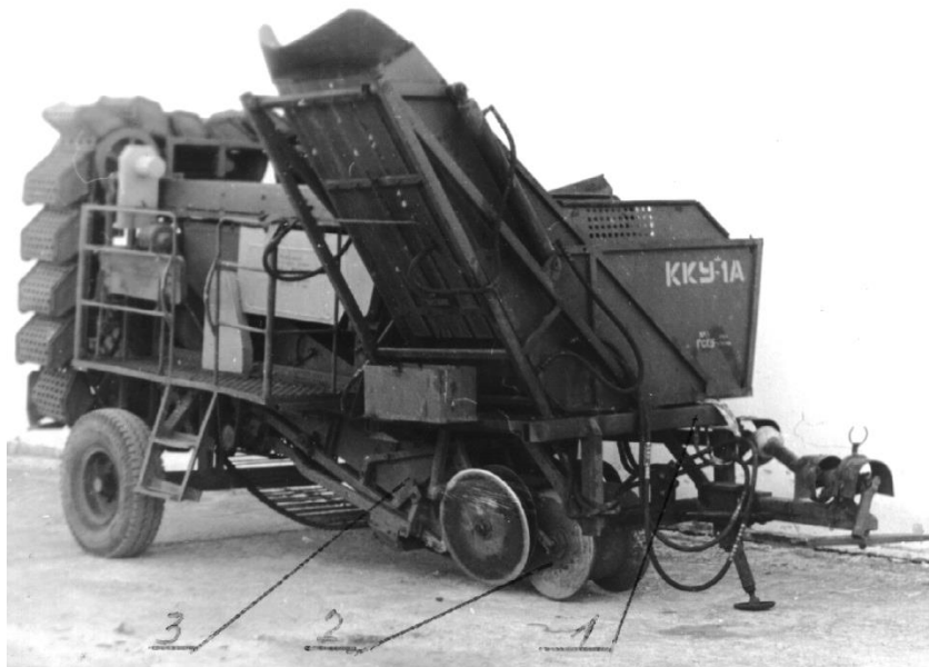
Рисунок 1 - Комбайн картофелеуборочный однорядный ККУ-1А-01: 1- рама; 2- каток опрессовывающий; 3-основной элеватор с подкапывающей секцией
