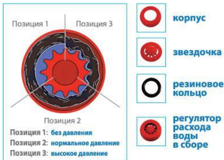
Рисунок 47 – Устройство и принцип действия регулятора расхода воды
