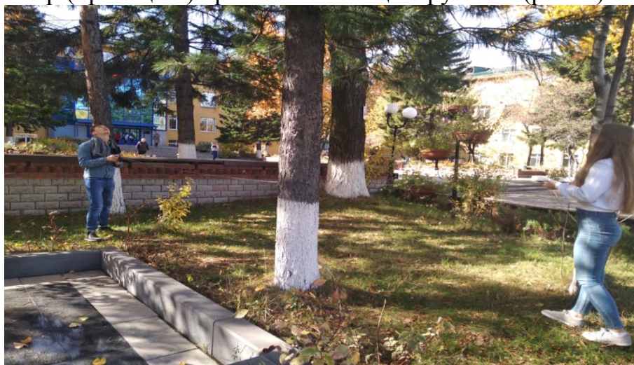
Рисунок 4 - Замеры диаметра (проекции) кроны с помощью рулетки
