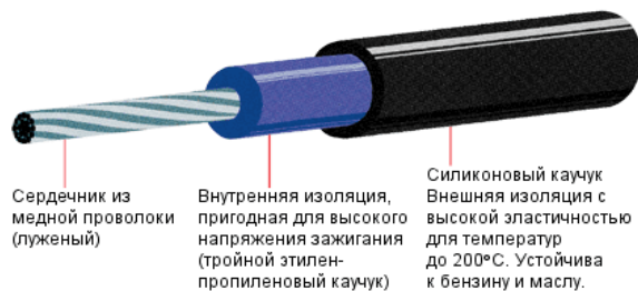
Рисунок 1 – Кабель с сердечником из медной проволоки
