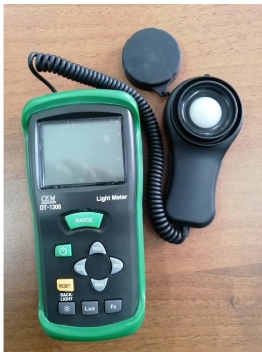
Рисунок 1 – Цифровой люксметр модели DT - 1308 для измерения параметров освещенности рабочих помещений
