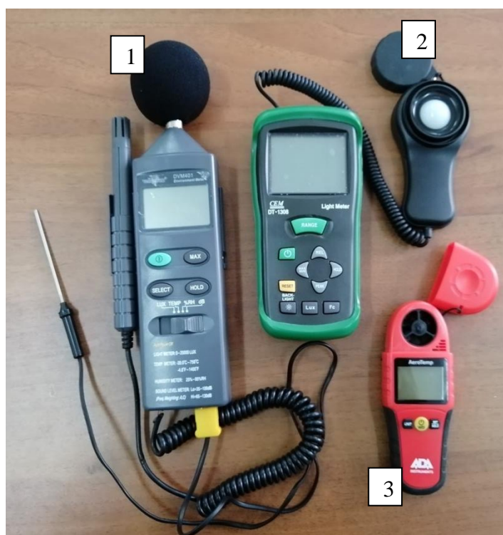
Рисунок 1 – Многофункциональный тестер DVM-401 для измерения параметров микроклимата рабочих помещений и анемометр:
