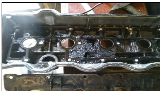
Рисунок 4 – Загрязнение маслоотделительной пластины
