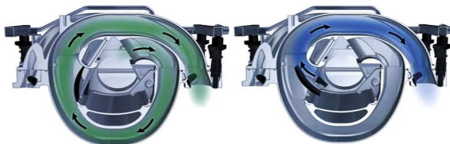
Рисунок 1 – Принцип работы впускного коллектора переменной длины
