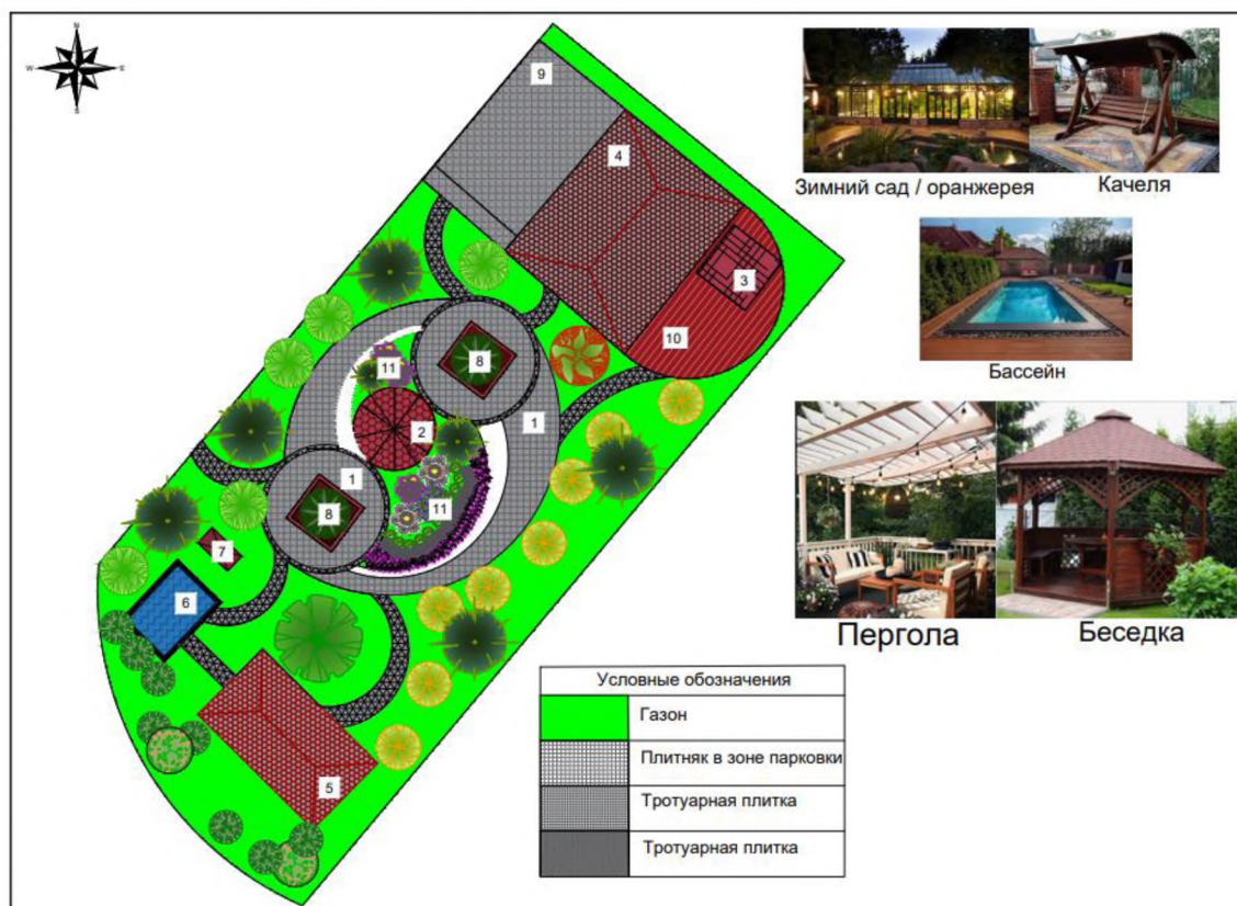
Рисунок 1 – Генеральный план: 1-дорожка, 2-беседка, 3-пергола, 4-дом, 5-зимний сад, 6-бассейн, 7-качеля садовая, 8-клумба с деревьями, 9- парковка, 10-терраса, 11-цветник
