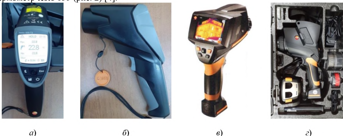
Рисунок 2 – Приборное оборудование для измерения и контроля температуры: а, б) компактный инфракрасный термометр testo 835; в, г) тепловизор testo 875i
