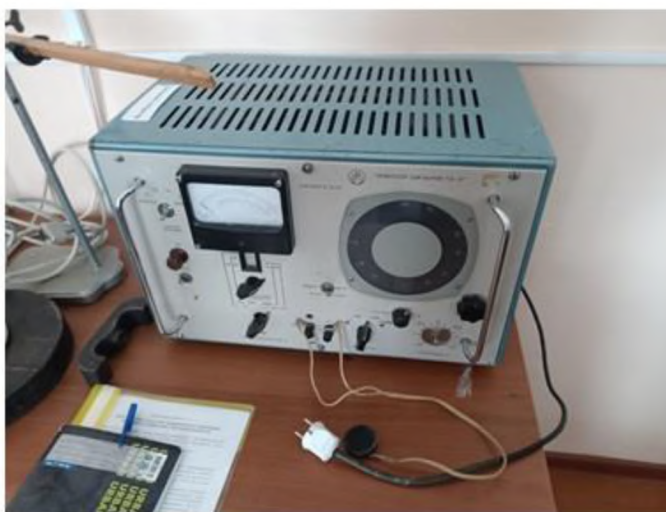
Рисунок 1 – Звуковые генераторы: «Генератор сигналов ГЗ-18 низкочастотный» (а), «Генератор сигналов ГЗ-33 звуковой» (б)
