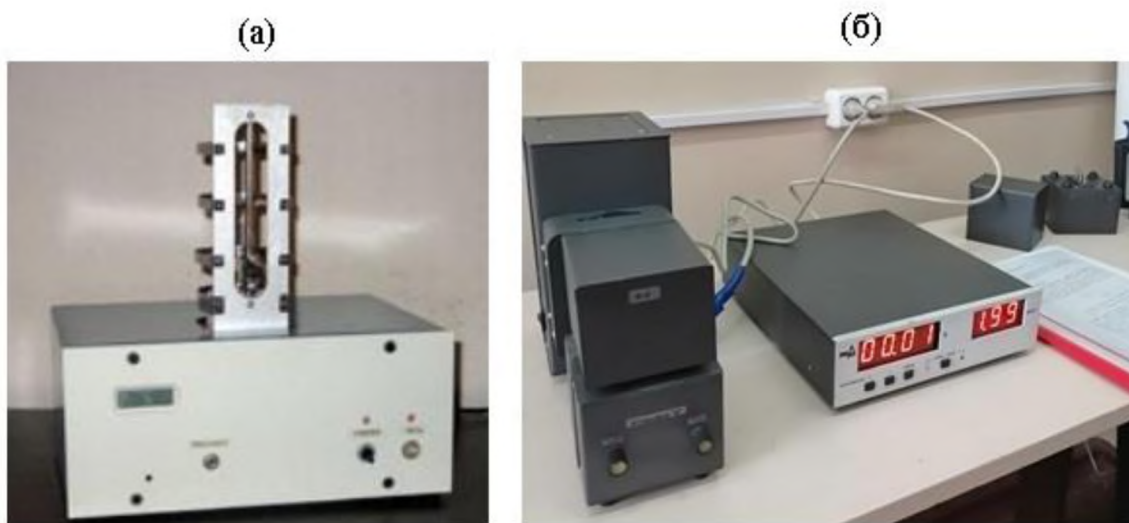
Рисунок 1 – Установка лабораторной работы «Определения удельной теплоты кристаллизации и изменения энтропии при охлаждении олова» (а); установка лабораторной работы «Изучение внешнего фотоэффекта» (б).
