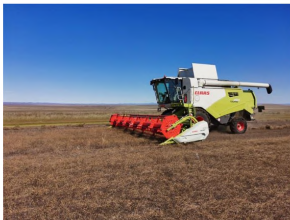
Рисунок 1 – Уборка льна масличного прямым комбинированием ЗУК TUCANO 450 с жаткой VARIO 930 в Иркутской области в 2022 г.
