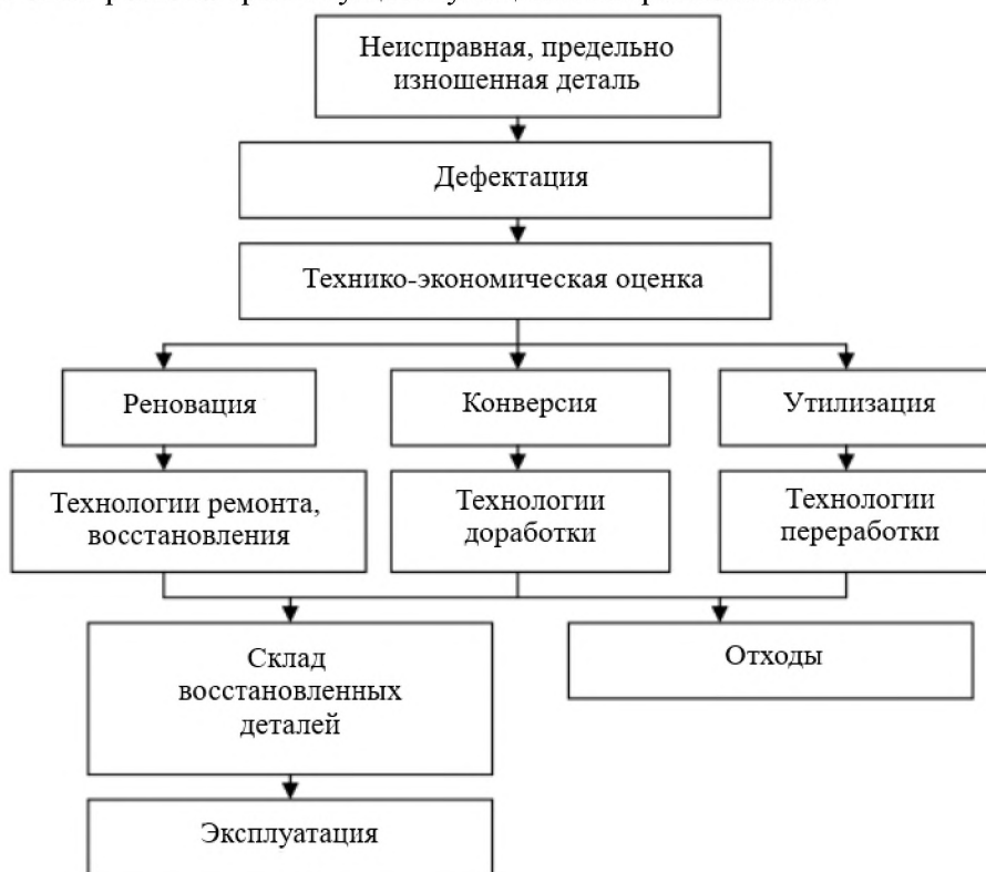
Рисунок 1 - Принципиальная схема рециклинга изношенных деталей
