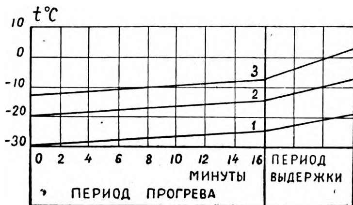
Рис. 2. Интенсивность подогрева 3-го коренного подшипника. 1 — при температуре -30^\circ ; 2 — при температуре -20^\circ ; 3 — при температуре -12^\circ .
