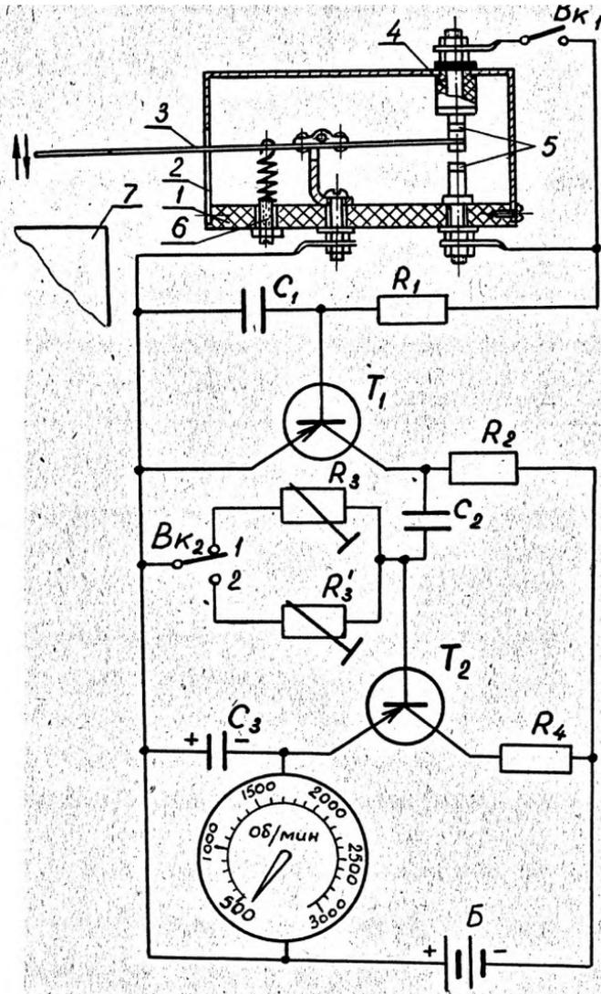
Схема прибора для измерения числа оборотов коленчатого вала двигателя по импульсам выхлопных газов.
